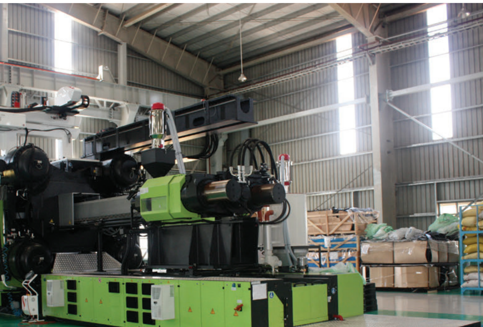
Máy ép phun nhựa 3.200 tấn sản xuất các linh kiện nội ngoại thất ô tô của Công ty ô tô Trường Hải
