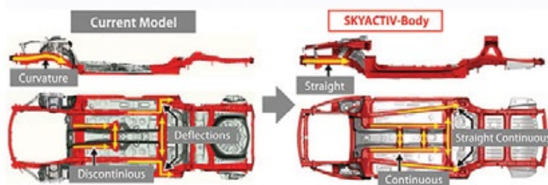
Hình 1.1. Kết cấu thân xe ứng dụng công nghệ SkyActiv so với thân xe thông thường Image 1.1. Vehicle body structure using SkyActiv Technology compared with conventional cars
