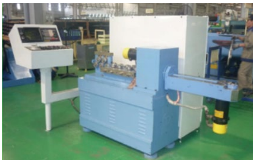
Hình 1: Máy uốn thép dây dùng công nghệ tự động CNC do 4 kỹ sư và thợ trung cấp công ty cơ khí thiết kế, chế tạo
