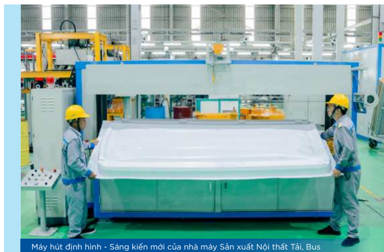
Máy hút định hình - Sáng kiến mới của nhà máy Sản xuất Nội thất Tải, Bus
