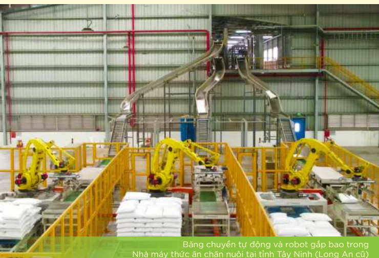
Hệ thống robot đưa các pallet lên thang máy nâng hạ tự động
