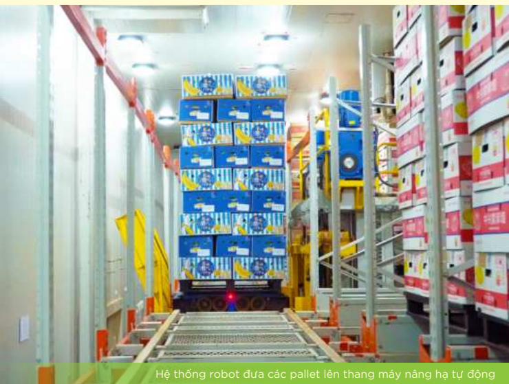
Hệ thống robot đưa các pallet lên thang máy nâng hạ tự động
